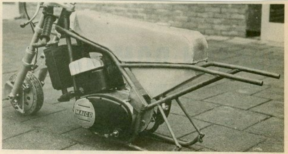
Op de linkerpagina de crosscombinatie voor Jan ten Thije. Hierboven en hieronder het wegraceframe voor de 125 cc-Maico. Ook de tank is een EML produkt, evenals de grote luchtfilterbak geheel boven (voor de zijspancombinatie).
