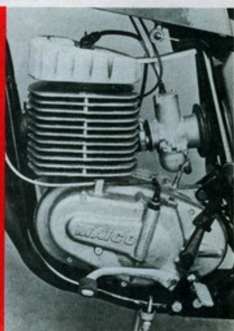
Linker pagina: De Maico MC 400 en de 250 Bultaco Pursang Mk IV. Boven: Cilinder en kop van de Maico MC 400. Let op de spijl in de uitlaatpoort, de bolvormige verbrandingsruimte en de twee bougies. Onder links: Moderne frameconstructie. Midden: Motor MC 250. Rechts: Krachtbron MC 400.
